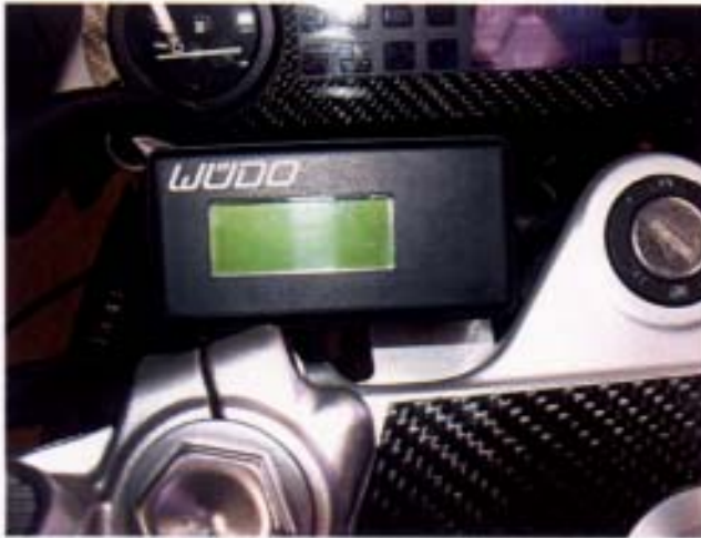
Jederzeit im Blick: Öldruck und Öltemperatur im zweizeiligen Display.
