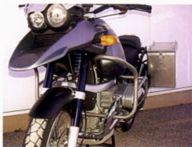
Schutz für Zylinder und Tank für R 1150 GS.
