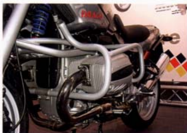
Schutz vorne und seitlich für R 1150 R ohne Einbuße an Schräglagenfreiheit.
