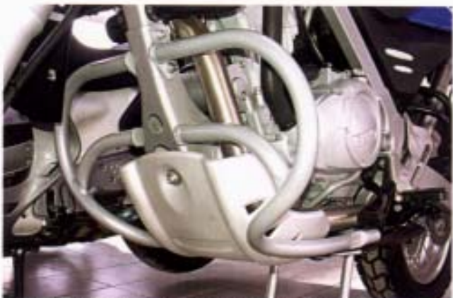
Stabil: H&B Motorschutzbügel für F 650 GS und Dakar.
