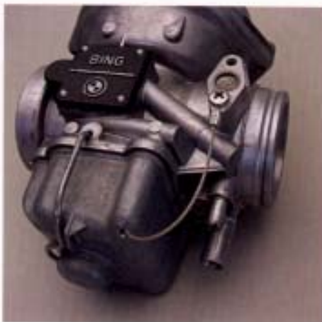
Kleine Teile – große Wirkung: Fangseile verhindern das Entschwinden der Schwimmerkammer (oben)
